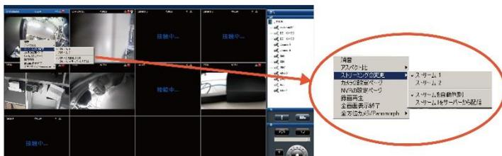
「ストリームを自動判別」が有効の場合、選択中のレイアウトに合わせて最適のストリームが表示されます。
