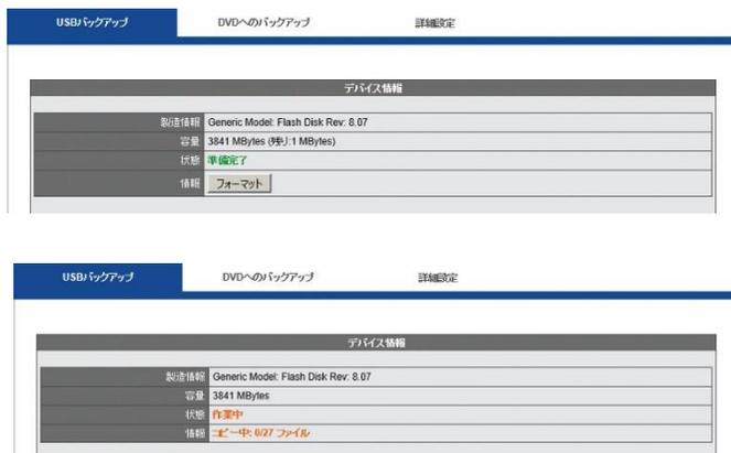
USB ストレージが「準備完了」になると、USB インディケータは青色で点灯します。バックアップを開始すると、状態が「作業中」となり、情報にはコピー中のファイル数が表示されます。
