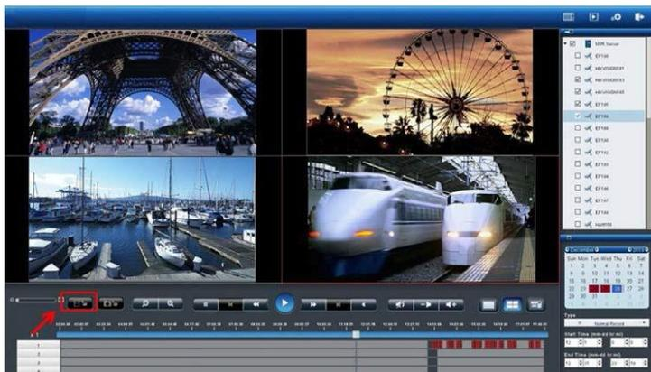
録画検索と同様に日付、時間を選択した後、バックアップボタンを押してバックアップを行ってください（※USB デバイスのフォーマットは FAT を使用してください）。
