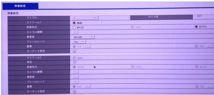
カメラがマルチ・ストリームに対応している場合、NVR は 2 本のストリームを取得できます。ストリーム 1 は録画用、及び 1~12 分割表示に使用するライブ映像用で普通は高画質設定を行います。ストリーム 2 は 16 分割以上の小さなライブ映像を表示するために使い、普通は低画質設定を行います。それぞれ最適の解像度、フレームレート、画質を設定してください。
