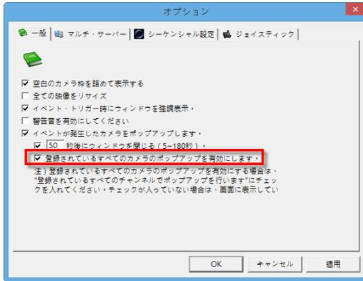
“登録されているすべてのカメラのポップアップを有効にします”を有効にすると、NVR のすべてのカメラにおいて、イベント発生時にポップアップを行います（※表示されていないカメラも含む）。
