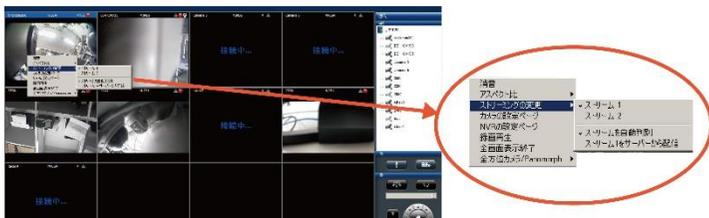
「ストリームを自動判別」が有効の場合、選択中のレイアウトに合わせて自動的に最適なストリームが選択され、表示されます。
