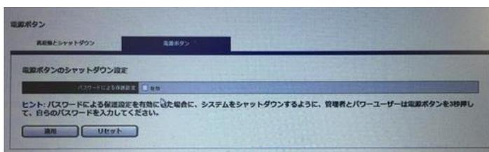
また、パスワードによる保護設定を行うと、電源ボタンを押した後、パスワードの入力を行いシャットダウンが行えます。
