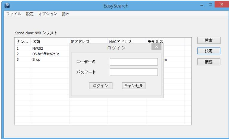
NVR の設定を変更する際、上記のようなダイアログが表示されるので、ユーザー名とパスワードを入力します。入力後、「ログイン」をクリックします。
