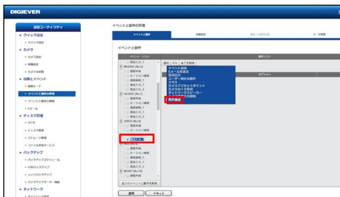
「イベントと動作」設定にて、対応カメラの IO 入力をクリック、「双方向通話」を選択します。ライブ映像に移行し、カメラの IO に入力が入ると、上記のように画面が切り替わり、単画面表示になります。他、拠点からボタンを押されるとリストに追加され、クリックすることで拠点を切り替えて対話ができます。
