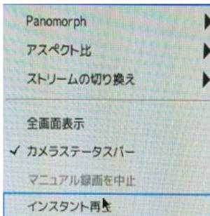
**1.魚眼補整モード（panomorph）：**全方位カメラ、または ImmerVision レンズを取り付けたカメラの映像を補整する際に使用できます。
