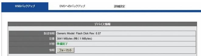
USB ストレージが「準備完了」になると、USB インジケータは青色で点灯します。バックアップを開始すると、状態が「作業中」となり、情報にはコピー中のファイル数が表示されます。
