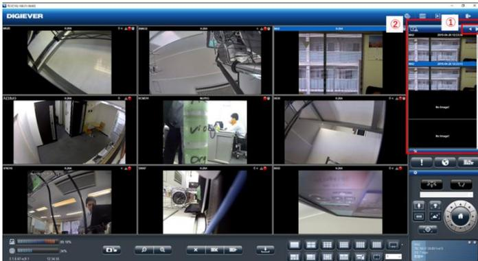
①の矢印をクリックしてアラーム画像表示モードに変更します。
