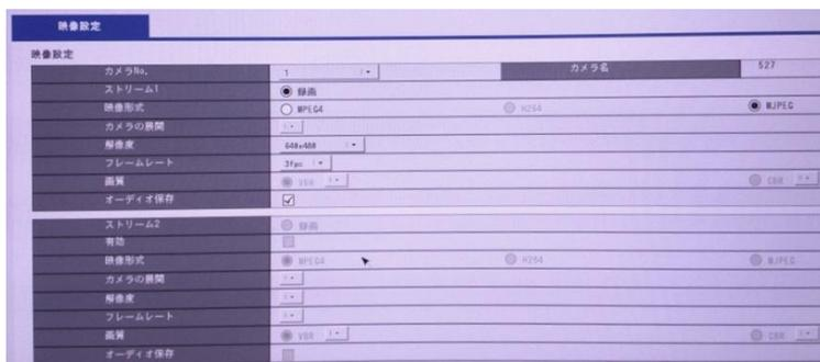
カメラがマルチ・ストリームに対応している場合、NVR は 2 本のストリームを取得できます。ストリーム 1 は録画用（※1～12 分割表示に使用するライブ映像用）、ストリーム 2 は 16 分割以上のライブ映像を表示するために使い、通常は低画質設定を行います。それぞれ最適な解像度、フレームレート、画質を設定してください。
