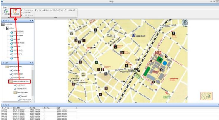
(2) マップパネル上でのマップの削除: 直接マップを選択し、右クリック→“マップの削除”よりマップの削除を行ってください。
