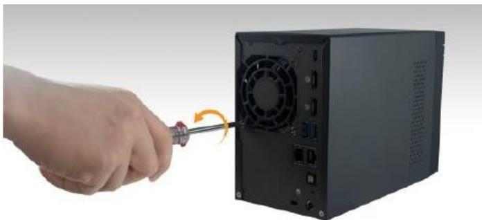
④取り外した箇所にブラケットを合わせ、ブラケット用のネジで固定してください。
