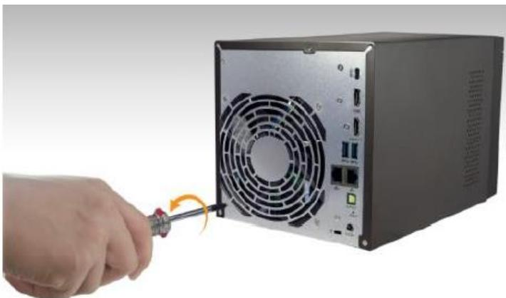
④取り外した箇所にブラケットを合わせ、ブラケット用のネジで固定してください。
