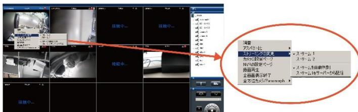
「ストリームを自動判別」が有効の場合、選択中のレイアウトに合わせて最適なストリームが表示されます。
