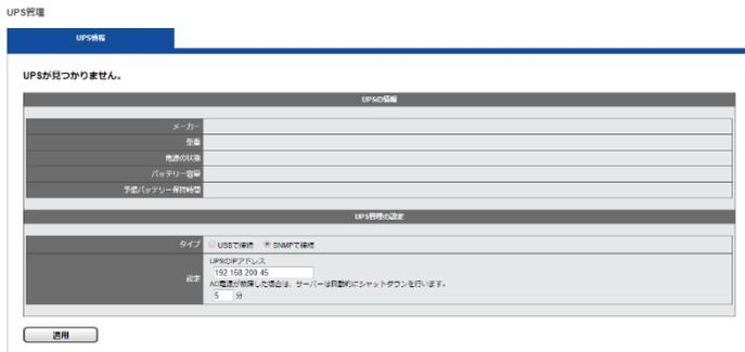
UPS の IP アドレスを指定し接続を行います。正常に接続が行われると、UPS の情報欄に機器の情報が表示されます。
