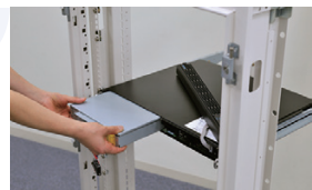
◀ ラック設置—バッテリー交換
